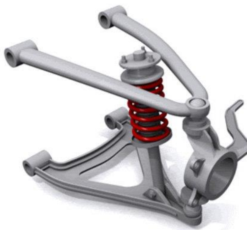
Figura 2.1: Suspensão Duplo A.
